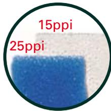
Der blaue Umfangsschwamm (Dichte ca. 25ppi) beugt der Verstopfung der Pumpe vor (mechanische Filtration), während der weiße Innenschwamm eine geringere Dichte aufweist (um eine übermäßige "Ermüdung" der Pumpe zu vermeiden) und vor allem die Funktion der biologischen Filtration erfüllt indem er den für die Klärung des Wassers zuständigen Bakterienkolonien eine ausgedehnte Fläche bietet. Der weiße Schwamm kann auch durch Bio-Balls oder Tonröllchen ersetzt werden.
